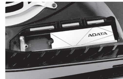
⑧ 上端から少し離れた位置(2cm程度)から、カバーをスライドさせて元の場所に取り付けます。カバーが固定されるとカチッという音がします。
