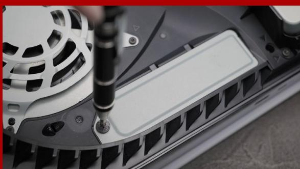
**LOOSEN THE SCREW TO REMOVE THE EXPANSION SLOT COVER.**
