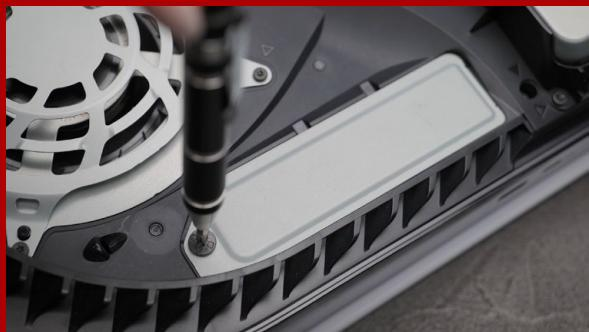
**REINSTALL THE EXPANSION SLOT COVER.**
