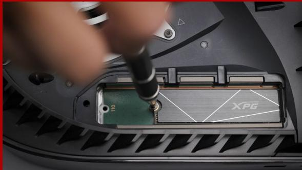
**FASTEN THE SSD WITH THE SCREW.**
