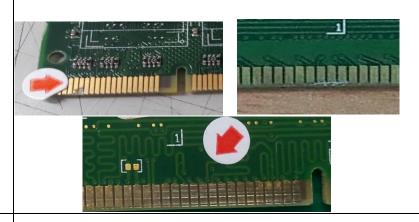
Connector scratched and corrosive 金手指金屬部 分有腐蝕性現象。
